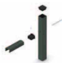
Instalação em poste intermédio.
